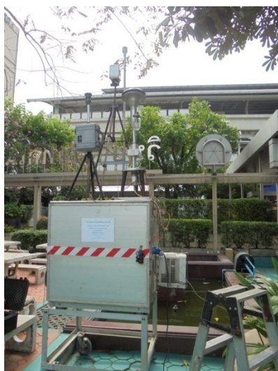
ติดตั้งเครื่องตรวจวัดฝุ่นละออง แบบ Gravimetric method ก๊าซมลพิษภายในพื้นที่โครงการ CO , NO 2 , SO 2 , THC เครื่องตรวจวัดเสียง และเครื่องวัดแรงสั่นสะเทือน วิทยาลัยเทคโนโลยีกรุงเทพ
