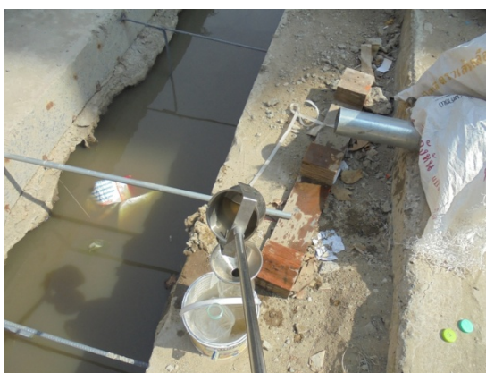
ติดตั้งเครื่องตรวจวัดฝุ่นละออง แบบ Gravimetric method ก๊าซมลพิษภายในพื้นที่โครงการ CO , NO 2 , SO 2 , THC เครื่องตรวจวัดเสียง และเครื่องวัดแรงสั่นสะเทือน ภายในพื้นที่โครงการ เก็บตัวอย่างน้ำทั้งก่อนระบายออกสู่ท่อระบายน้ำสาธารณะ
